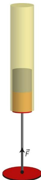
Utenpå aluminiumsrøret monteres ei fjær med fjærstivhet på 100 N/m som på figuren til høyre. Når magneten presses opp gjennom røret, presses samtidig fjæra sammen.
