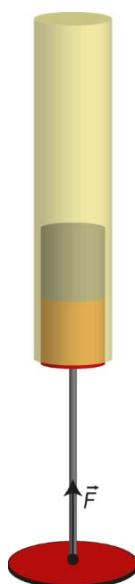
Utanpå aluminiumsrøyret blir det montert ei fjør med fjørstivleik på 100 N/m som på figuren til høgre. Når magneten blir pressa opp gjennom røyret, blir fjøra samtidig pressa saman.
